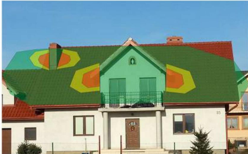
Rys. 1 Strefy zacienienia na dachu skierowanym na południe
